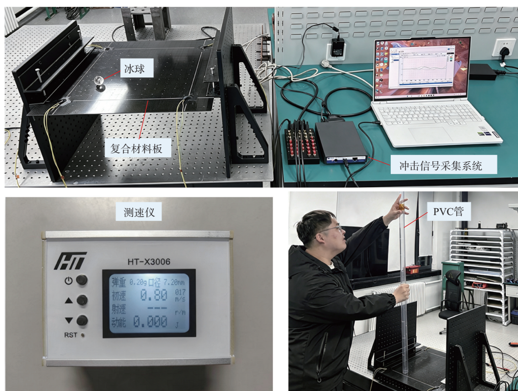
图2 复合材料板冰球冲击试验装置
