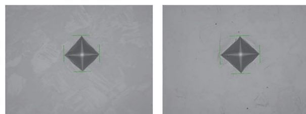
(a) 原始态母材 (b) 经过钎焊热循环的母材
