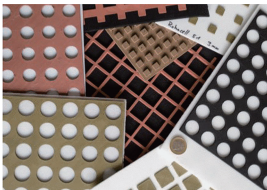
(c) 用于 30 GHz 吸收器的印刷立方体结构, 右侧为 10 GHz FSS 吸收器的尺寸 [80]
