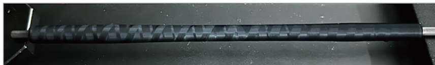
(b) 石墨棒上往复缠绕工艺制备的 SACNT-SF
