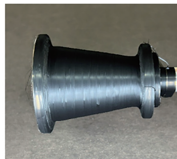
(b) 表面包裹 SACNT-SF 后的异形零件
