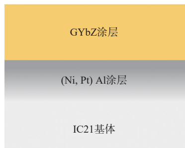
图1 GYbZ 涂层结构示意图 Fig.1 Schematic representation of GYbZ coating
