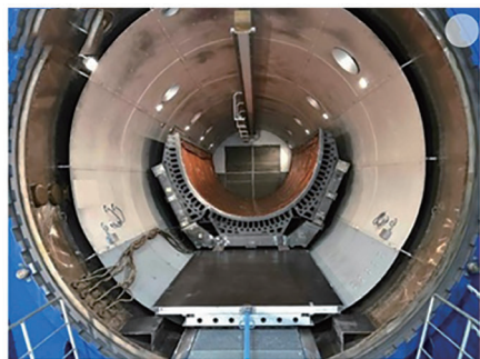
(b) 热压罐固结机身下部
