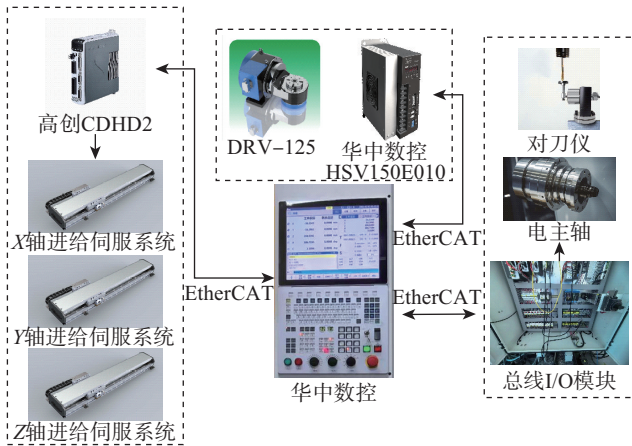
(a) 四轴加工中心硬件连接架构
