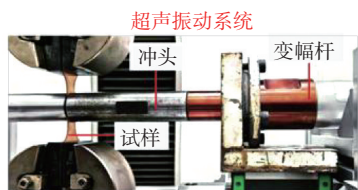
(a) 超声振动法向激励单向拉伸试验装置 [83]
