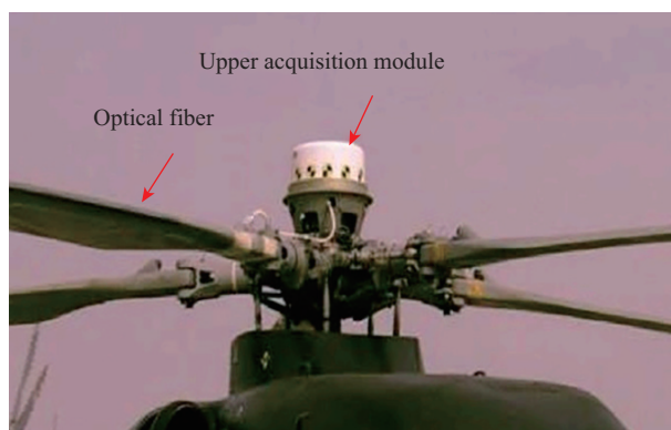
图11 安装于旋翼上的FBG动态应变测量系统 [48]
