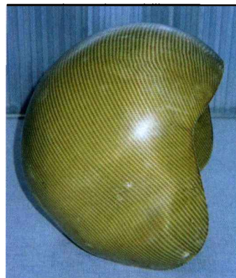
图4 RTM成型的复合材料头盔
