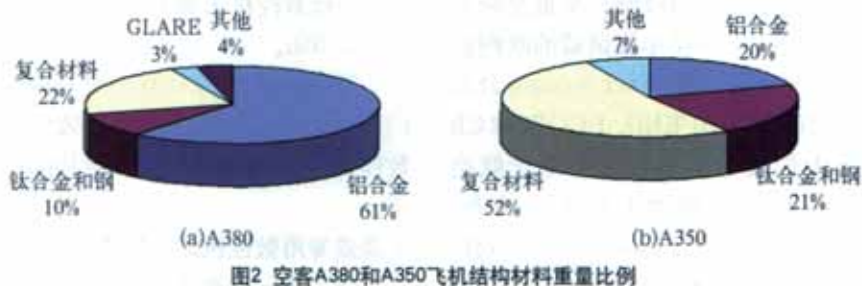
图2 空客A380和A350飞机结构材料重量比例
