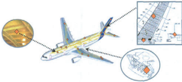
图1 国外飞机采用FBG传感器网络进行结构健康监测示意图
