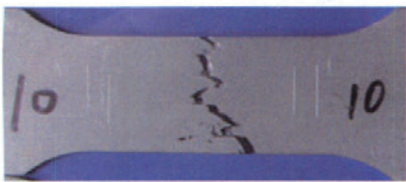
图3 W1的表层金属断口形貌
