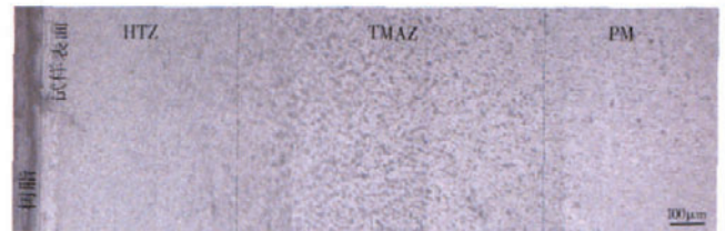
图5 20# 钢接头接触面(左)至母材(右)的显微组织
