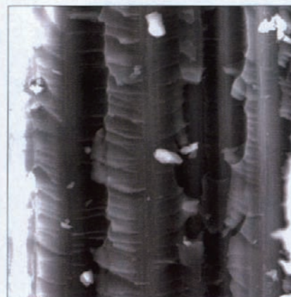
图2 CCF300纤维增强复合材料断面形貌
