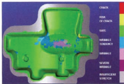
图7 液室压力为10MPa时的模拟结果 Fig.7 Simulation result at hydro pressure 10MPa
