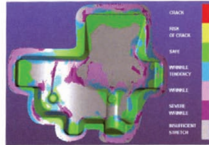
图 15 压边间隙为 0.61mm 的模拟结果
