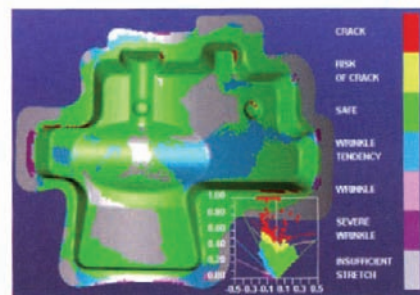
图11 反胀压力为1MPa的模拟结果 Fig.11 Simulation result at inverse bulging pressure 1MPa
