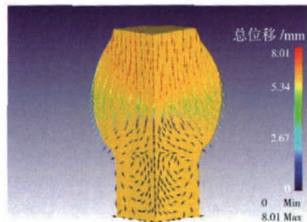
图8 预成形时工件材料流动方向
