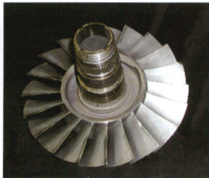
图2 Optomec公司开发的LENS 850成形机及成形件
