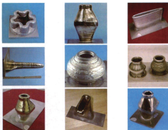
图4 美国宇航局兰利研究中心(NASA Langley Research Center) EBM成形与后加工的样品
