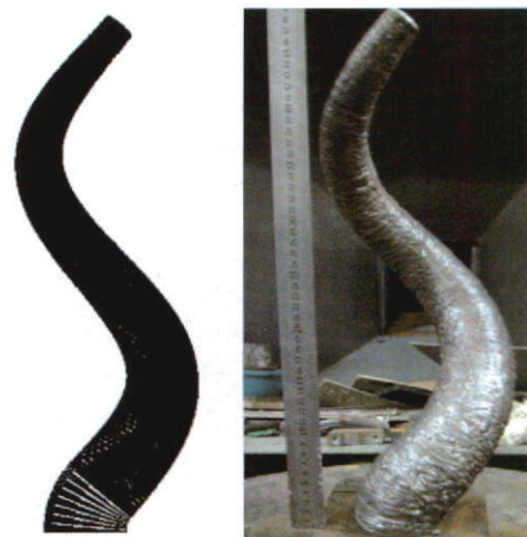
图6 采用变向变厚楔形切片算法制造的变向渐缩式316不锈钢空间螺旋管
