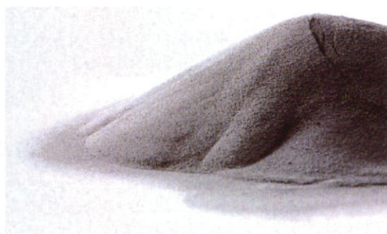
图5 EBM技术所用的粉末金属
