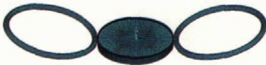
图3 轮圈旋压成形的有限元模型
