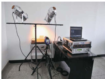
图1 红外热成像检测系统组成
