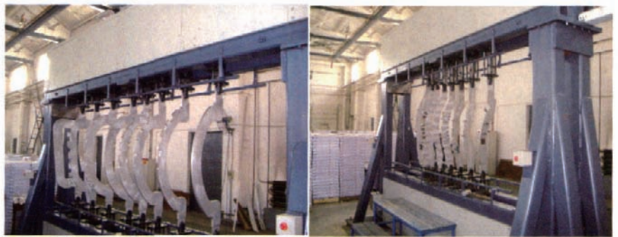
图6 数控柔性装配型架的应用验证
