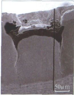
图4 硬质合金刀具磨损微观形态
