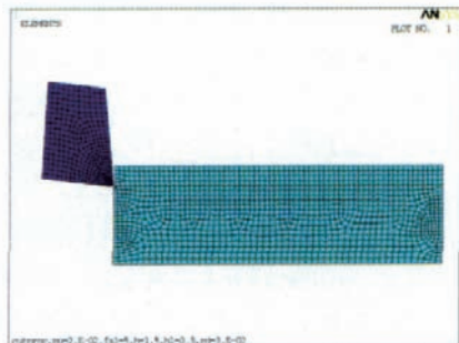
图6 刀具有圆角前角5°时的有限元模型
