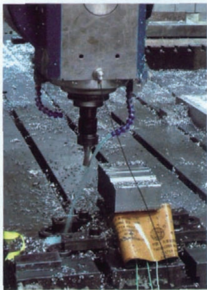
图1 钛合金铣削试验现场 (切削力及振动)
