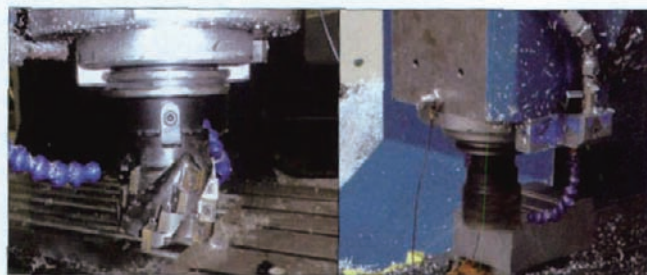
图5 玉米铣刀铣削钛合金平面
