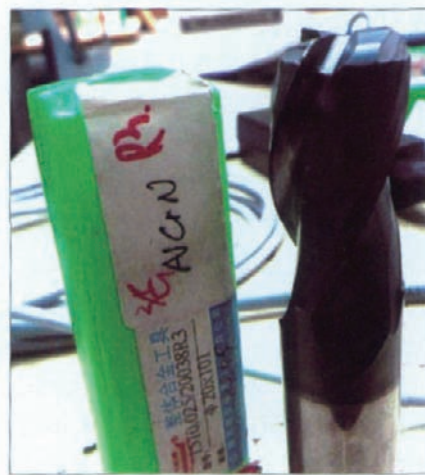
图3 AlCrN涂层硬质合金刀具
