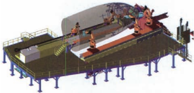
图2 串联机器人制孔 (图为波音787-41段中机器人辅助机头/前机身装配) Fig.2 Series robot drilling
