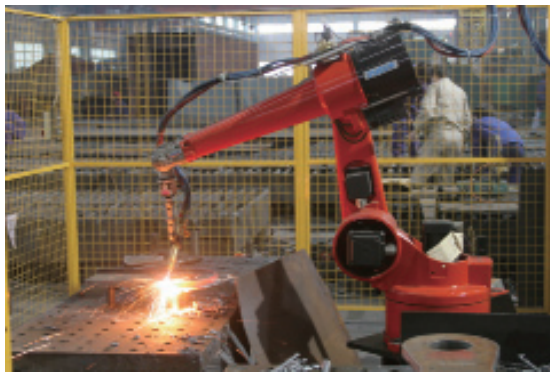
图1 机器人为铝合金组件切边
