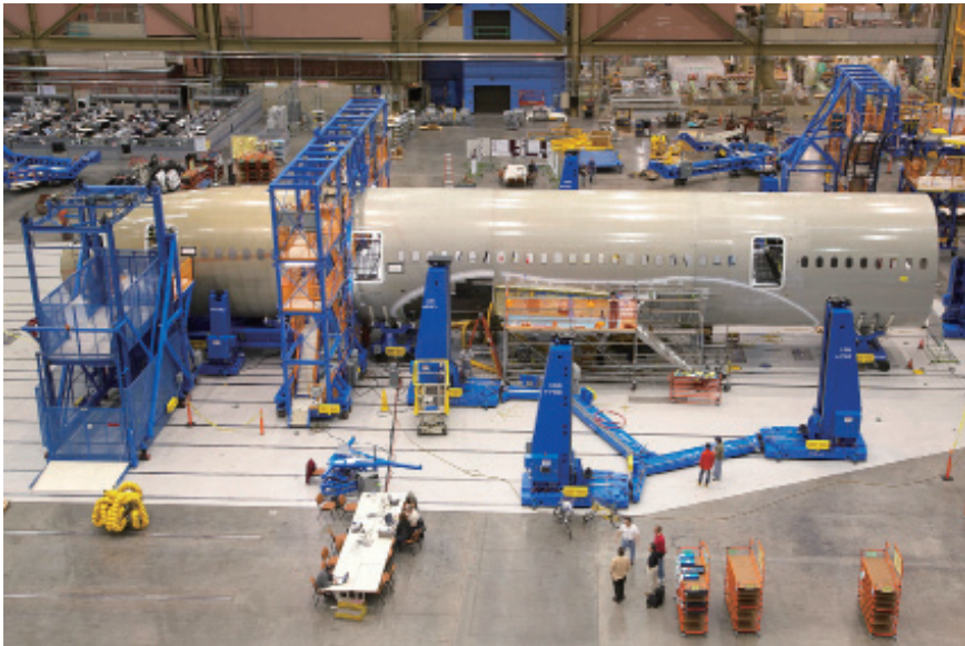
图2 波音787的混联结构定位
