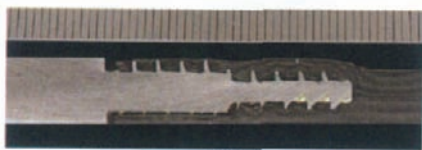
图5 用于金属/复合材料连接的Comeld接头
