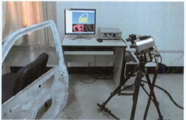
(b) ReCreator 进行表面点云测量测现场
