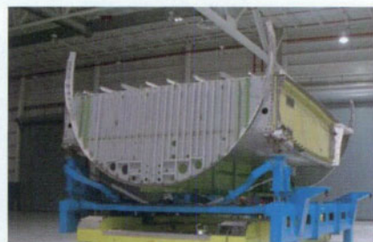
图1 787的11和45段 (已装配成一体)
