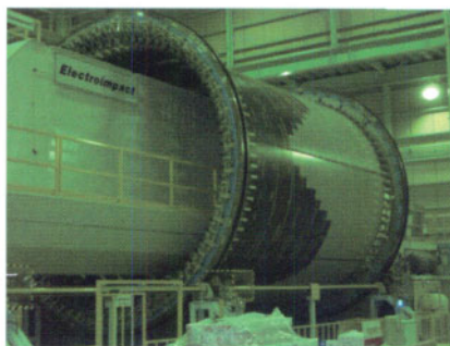
图7 柱式数字化铆接机械工作情况
