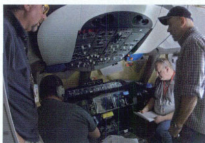
图8 机头部件41段的装配和安装过程
