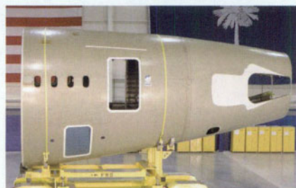
图2 787机身47和48段 (已装配成一体)
