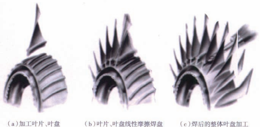
图2 整体叶盘线性摩擦焊的工艺过程
