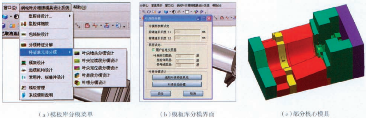
图8 基于模板库的某涡轮叶片分模过程
