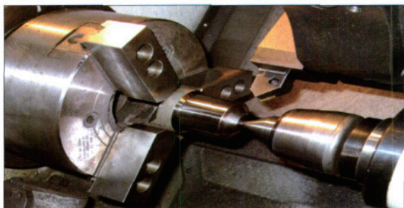
图1 硬质合金刀片车削加工实例
