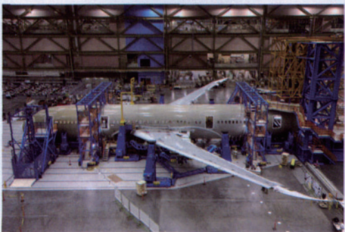
图7 波音787的六大部件对接总装
