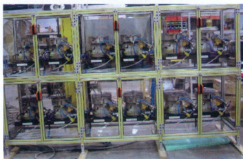
图5 GEMCOR自动钻铆机的送料装置
