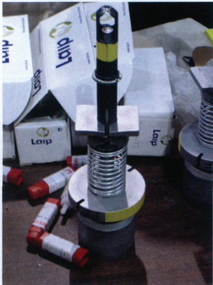
图7 液压为动力自动钻铆系统的夹钉装置
