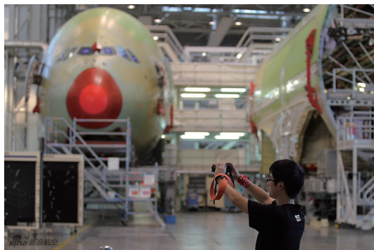
图 2 A380 机身外形照相法测量
