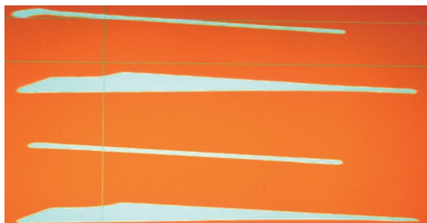
图5 扩压器试件的超声波检测图
