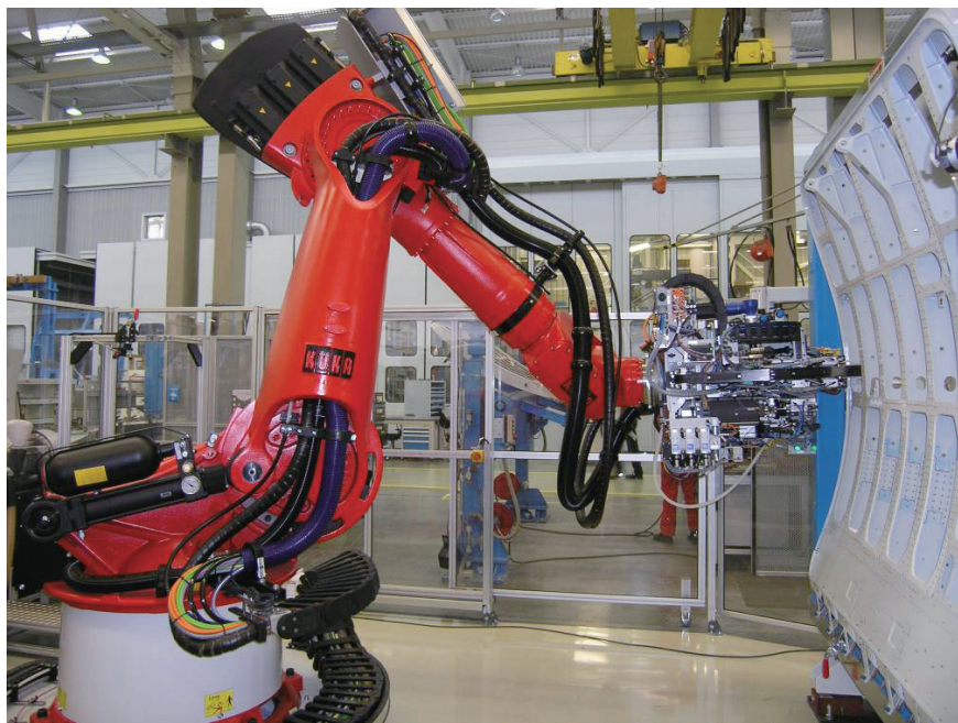
图1 宝捷公司的Race机器人制孔系统
