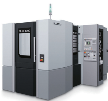
图2 德马吉森精机NHC4000卧式加工中心
