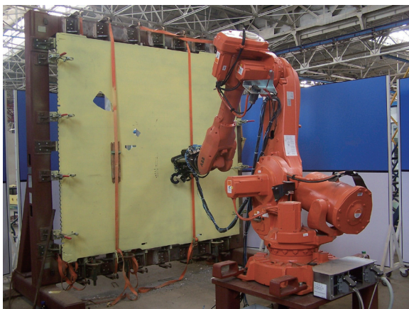
图5 自动制孔试验现场 Fig.5 Test site of automatic drilling
