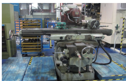
图2 现用于加工榫槽的非标铣床
