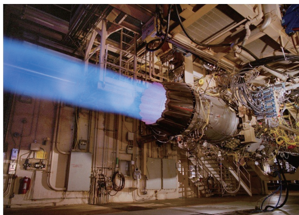
图1 F135发动机在试车台上进行性能测试
