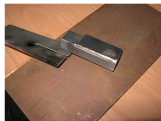
(b) 端边厚度 0.5mm、顶角 60° 的试验件
