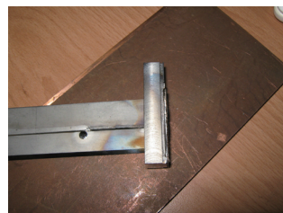
(a) 端边厚度 0.5mm、顶角 45° 的试验件
