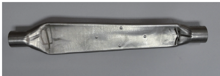
图3 航空发动机高压涡轮导向器叶片衬管
