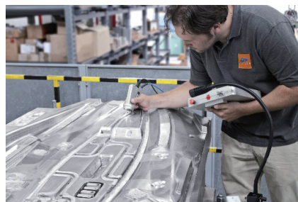
图9 模具的激光修复
