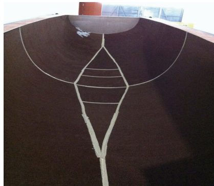
图7 拼接、稳定化处理后的蜂窝芯
