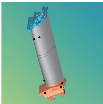
图3 叶片6点迭代基准点示意图
