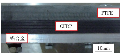
图1 PTFE、CFRP和铝合金叠层板料 Fig.1 PTFE/CFRP/aluminium stacks
