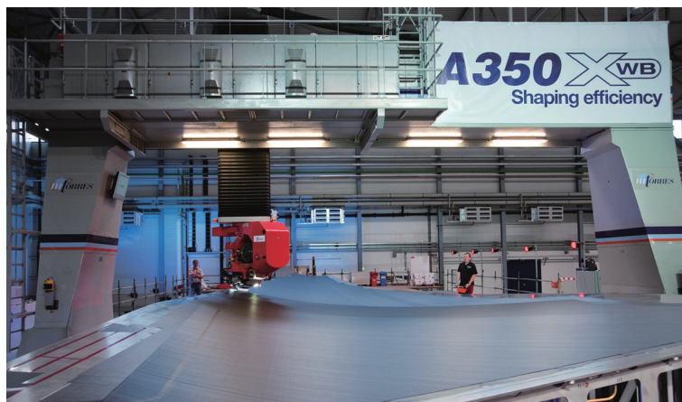
图2 A350机翼蒙皮自动铺带
