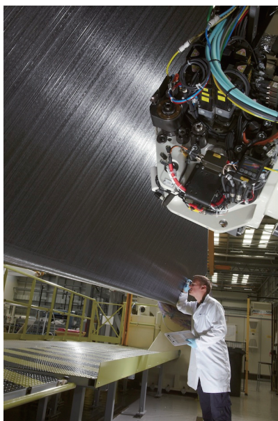
图4 A350XWB翼梁自动铺丝检查
