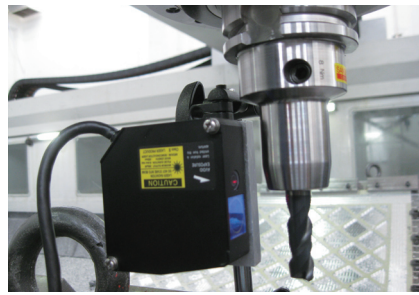
图2 径向位移跳动测量现场图
