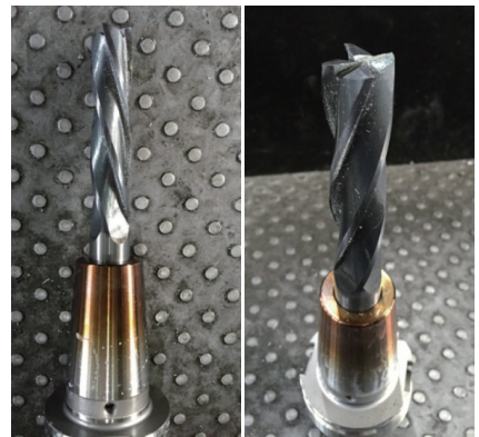
图12 热缩刀柄夹持的SECO \phi 20mm 整体硬质合金立铣刀
