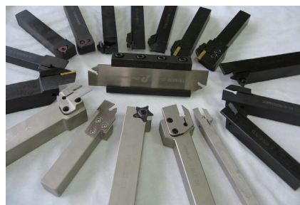
图2 机夹式切槽刀具
